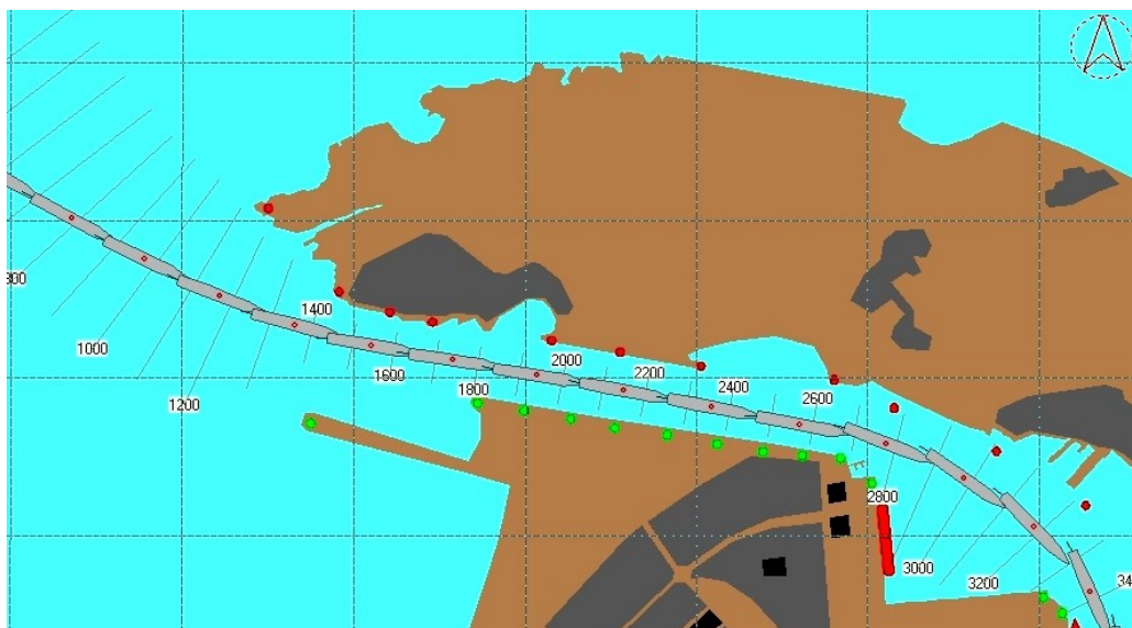
Figura 1. Ejemplo de una trayectoria de acceso de un crucero de 225 m de eslora. Viento del NW de 10 nudos. Tramos de enfilación, canal y curva de Pachico
