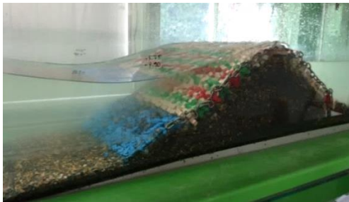
Figura 4. Sección tipo del rompeolas ensayada.
