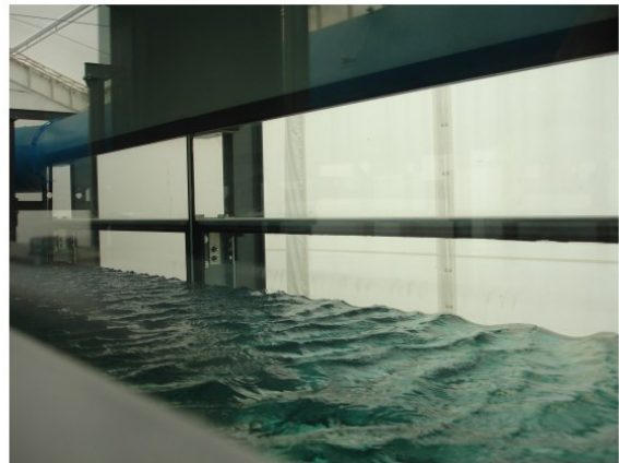
Figura 2. Serie temporal y vista de oleaje generado por viento en el Canal de Interacción Atmósfera-Océano
