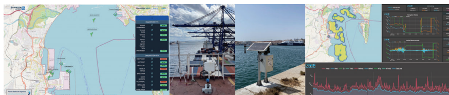
Figura 1. De izquierda a derecha. Captura de la red de medida desplegada. Instrumento DeepMOTION instalado en buque. Instrumento DeepWAVES instalado en muelle. Ejemplo de datos adquiridos: Mapa de densidad de posicionamiento y series temporales de movimientos del buque y parámetros de oleaje locales
