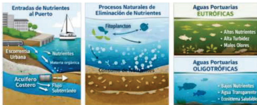
Fig. 1 Entradas, procesos naturales y estados de nutrientes en aguas del puerto
