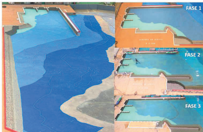
Fig. 1 Modelo 3D de la Dársena de África. Fuente: CEDEX
