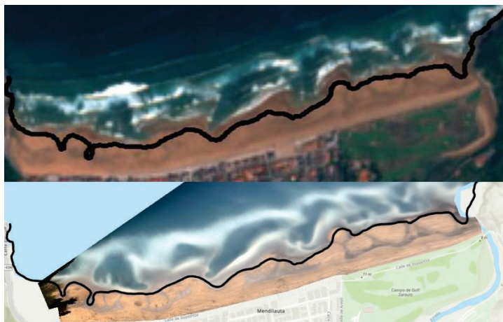
Fig. 1 Línea de orilla 18-05-2022 a las 11:09. Arriba: Imagen Sentinel-2 y línea de orilla detectada por CoastSat. Abajo: Misma línea de orilla pintada sobre imagen timex de KOSTASystem
