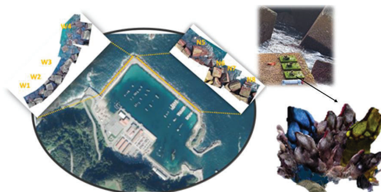
Fig. 1 Cubos oeste (W1, 2, 3 y 4) y norte (N1, 2, 3 y 4), detalle de cubo y escaneado 3D
