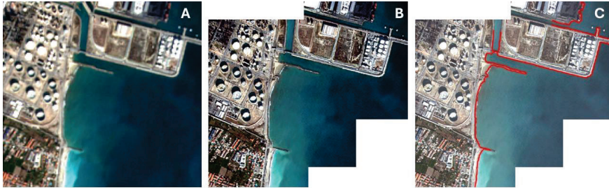
Fig. 1. (A) Imagen Sentinel-2 sobre Castellón el 21/12/2023. (B) Imagen superresuelta. (C) línea de costa resultante
